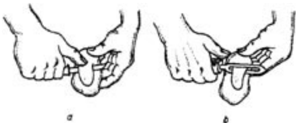
Slika 30. Ljuštenje krumpira nožem s tankom drškom (a) treba izbjegavati zbog velikog opterećenja zadnjih prstiju šake, Odebljanjem drške smanjuje se opterećenje (b)
