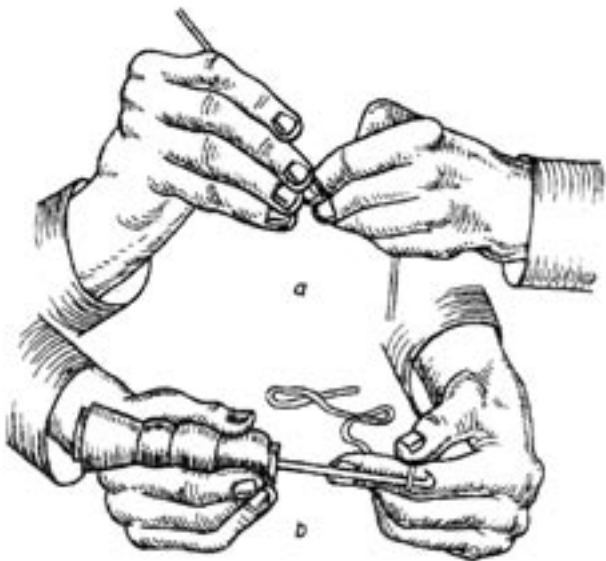
Slika 44. Pletenje iglama tankih drški veoma opterećuje male zglobove (a); ako su drški deblji, opterećenje se smanjuje (b) .
